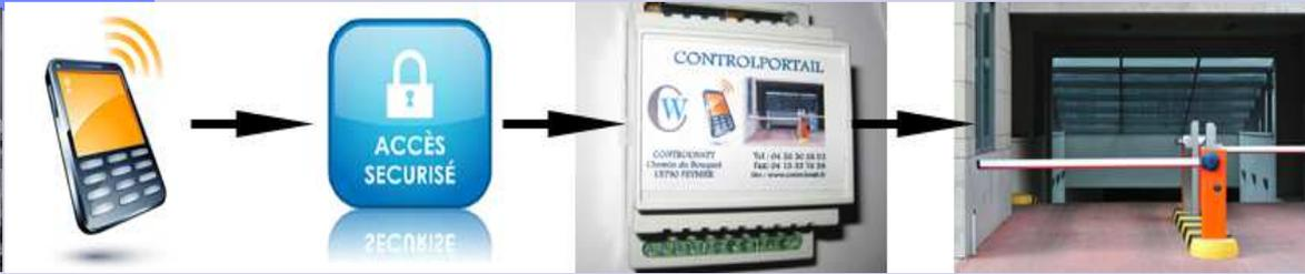
CONTROLCOMMANDE permet aux utilisateurs autorisés selon des plages horaires de piloter à distance tous types d'automatismes par un simple appel (éclairage, vanne, moteur électrique, etc...) et de recevoir des informations par SMS depuis trois capteurs de votre choix !
